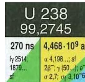
In der linken Spalte ist der metastabile Grundzustand dargestellt, der eine Halbwertszeit von 270 ns besitzt. Der Ausdruck  $|\gamma$  steht für Gamma-Quanten (der Energie 2514 keV und 1879 keV und weitere), die beim Zerfall desselben Nuklids in den Grundzustand entstehen. Der Term sf steht für Spontanzerfall (spontaneous fission) des Nuklids.
