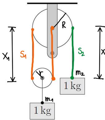
Berechnen Sie die Beschleunigung der an dem Flaschenzug angehängten identischen Massen (1 kg) aufgrund der Erdanziehung! Wie groß ist die Zugkraft, die das Seil aushalten muss? (siehe Abbildung links)
